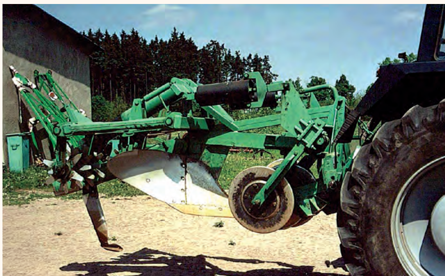
Fot. 33. Pług do pełnej i głębokiej orki na glebach zdegradowanych i zachwaszczonych ( fot. A. Sobania )
